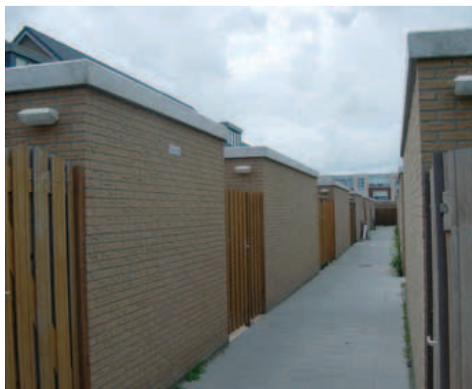
Verlichting op deze wijze binnen dertig centimeter van de erfrens en maximale onderlinge afstand van twaalf meter
