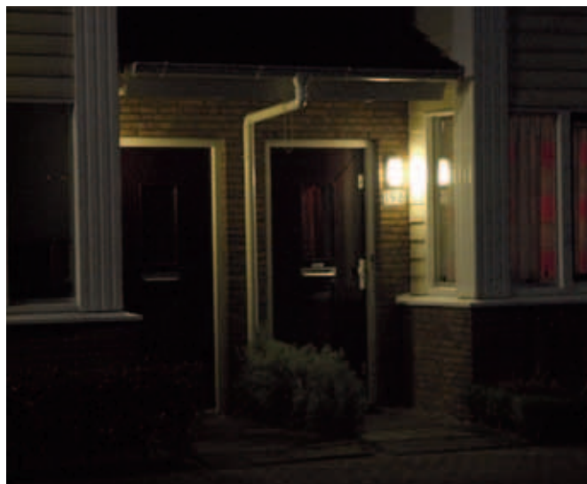
Het meest effectief is verlichtingsarmatuur aangebracht naast de sluitzijde van de deur
